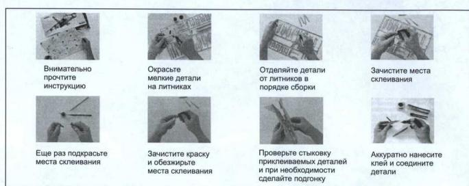
Перед сборкой модели внимательно прочтите инструкцию, проверьте наличие деталей на литниках. Отделяйте детали от литников только по мере их надобности в процессе сборки. Обратите внимание на то, что некоторые детали удобнее окрашивать до окончательной сборки модели (номера красок для этих деталей указаны непосредственно на схеме сборки). Пользуйтесь инструментом, клеем и красками, соблюдайте необходимые меры предосторожности, работайте только в проветриваемом помещении.
