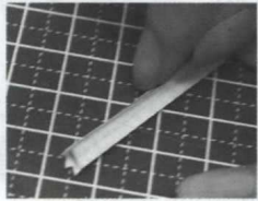
4 真ん中の線で折り返して両面テープの保護紙を剥がし、接着します。
