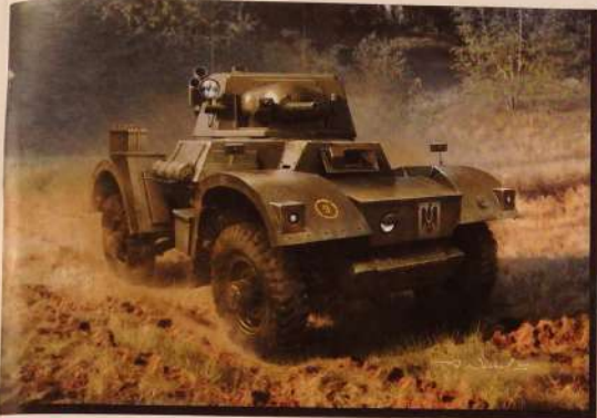
繁體中文 戴姆勒裝甲車的設計始於伯明翰小型武器公司 (BSA) 的一項「輪式坦克」設計研究，按照他們自己的小型偵察車開發的設計計劃，採用四輪驅動和後置發動機。「輪式坦克」基本上是他們偵察車的一個放大版本，帶有一個懸掛在頂部的小型小火炮。
