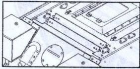
Жалюзи C57 и C56 можно приклеить в открытом положении. Install the cooling flaps C57 and C56 in open or closed position
