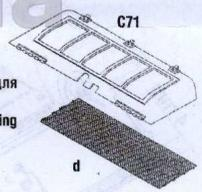
Используйте «Супер Момент» для приклеивания пластиковой сетки. Use Superglue for wire netting mounting. Дополнительная деталь «d» «d» additional part
