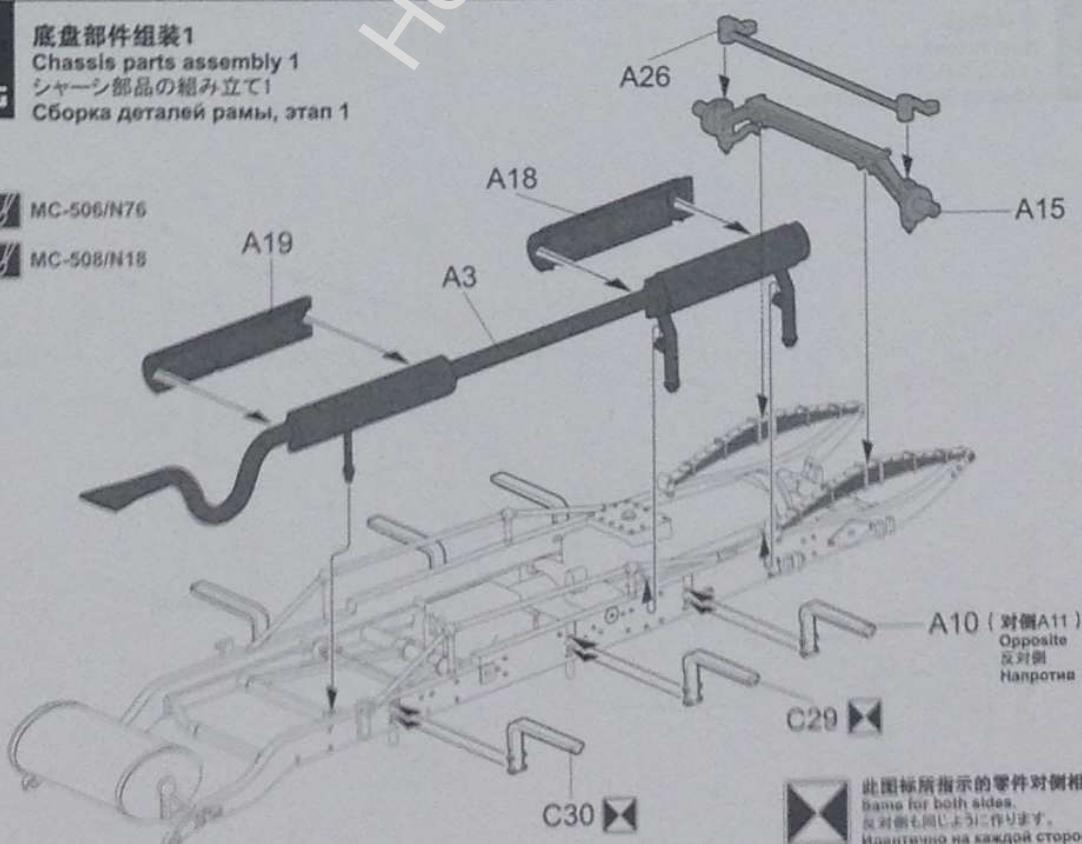
此图标所指示的零件对称制作。
