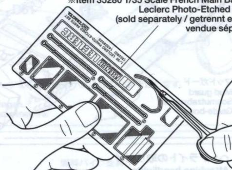
①別売のエッチングパーツを取り付ける方は別売のエッチングばさみを使って切り出します。
