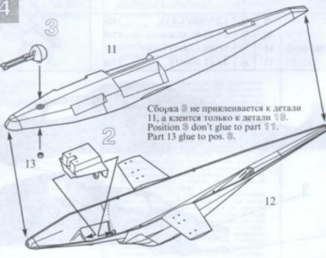
Сборка ③ не приклеивается к детали 11, а клеится только к детали 12.
