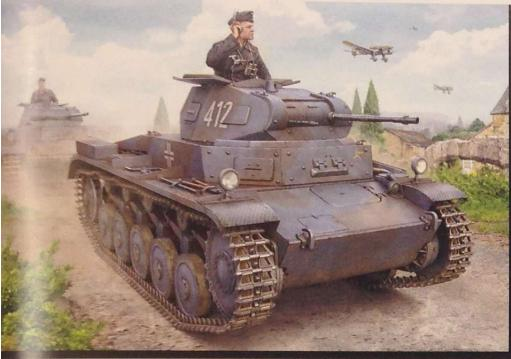
**重要中文** Panzerkampfwagen II是為德國軍隊開發的第二款坦克，始於1934年。最初的規格是一輛配備2釐米KwK.30 L/55加農炮的作戰坦克，該砲可以在500米處穿透14毫米的裝甲。1935年，克虜伯公司開始建造PzKpfw II，第一輛坦克於1937年投入使用。Ausf A、B和C是同一型號，內部略有變化，坦克重8.9噸，最大裝甲為14毫米。由138匹馬力的邁巴赫HL62 TRM汽油發動機提供動力，最大公路行駛速度為40公里/小時，而越野行駛速度為24.5公里/小時，續航里程為190公里。在波蘭戰役後，一些坦克獲得了額外的正面裝甲和改良的指揮官圓頂，這些坦克將在1940年的法國戰役中作戰。PzKpfw II被許多法國和英國坦克擊敗，但通過大量部署來彌補這一點。到1940年，PzKpfw III和IV已經服役，並開始在前線部隊取代PzKpfw II。然而該坦克被使用到大戰末。
